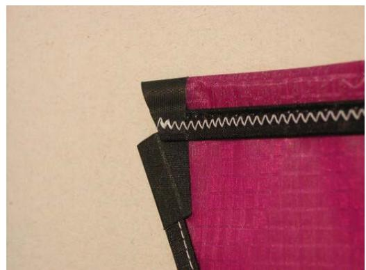
19. Nun die untere Stabführung an der Schwanzunterkante nach hinten umklappen und festnähen. An den Schwanzecken ein kleines Rechteck ausschneiden (ca. 6mm x 12mm). Hier findet später die Splitkappe ihren Platz. Den Drachen einmal der Länge nach falten. An der Unterkante eine Aussparung für die Splitnocke des Mittelstabes freischneiden.
