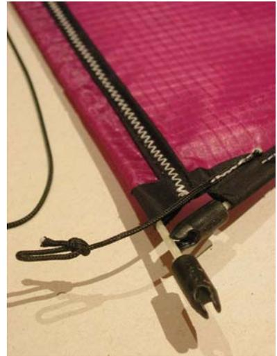
21. An der Spitze eine Bandschleife aufnähen. Hier wird später der Stab mit einer Pfeilnocke eingehängt. Die Schlaufe sollte nur bis zur Oberkante gehen.
