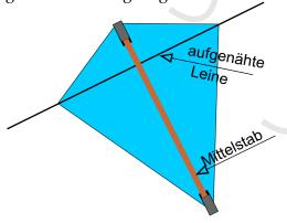
Zuerst schneiden wir die Segel aus. Wer sie heiß schneidet, braucht nicht einmal zu säumen. Achtung! Nicht aus Versehen das Mittelloch mit ausschneiden, DIESE Kette braucht keins! Oben und unten wird eine Stabtasche aufgenäht. Dann nehmen wir eine Nylonschnur (1,5mm) und nähen alle Segel quer mit ca. 75cm Abstand darauf fest. Das ist
