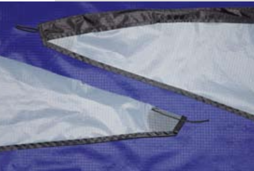
Die Flügelspitzen erhalten eine Schnurschleufe und werden anschließend mit der Tasche versehen
