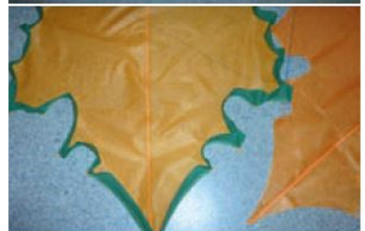
Zuschnitt des Schleppsacks und umlaufendes Band als Profil
