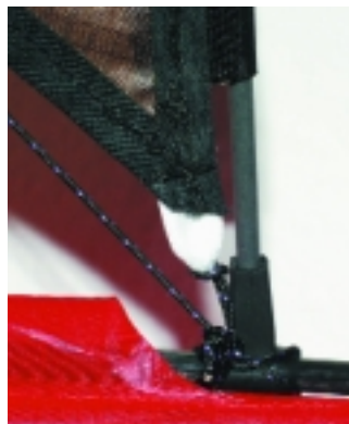
Das obere Ende des Rumpfes wird an den Segelstab gebunden
