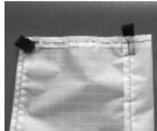
Nach exakt dem gleichen Schema werden die beiden Tragflächen angefertigt. Zunächst wird Flatterkante und Aussenkante samt Tascheneingang gesäumt, anschließend die Stabtasche gefaltet und festgenäht um abschließend die Laschen für die Spanngummis aufzunähen.
