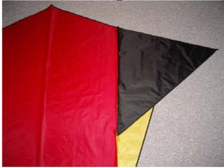
Als nächsten Schritt die beiden Hälften ebenfalls mit einer geschlossenen Kappnaht verbinden.
