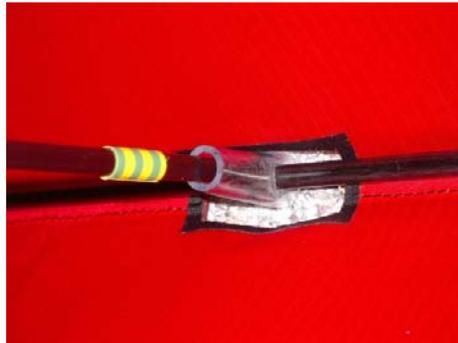
Damit das Schlauchstück am Mittelstab nicht das Segel aufreißt, wird diese Stelle mit Klebedacron verstärkt und eine Öffnung heiß frei-geschnitten
