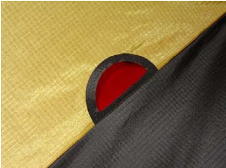
Nun noch die Verstärkungen (D=80mm) aufkleben, festnähen und die Löcher ausschneiden. Bei einer größeren Version dieses Drachen würde ich zusätzlich den Querstab an den Durchgangslöchern fixieren (mit einer Schlaufe festknoten) Dies verhindert, dass sich der Querstab unter Druck zu sehr verbiegt und unkontrolliert ausweicht.
